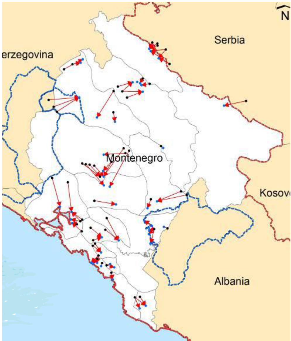
Slika 3.42. Pravci tečenja podzemnih voda
